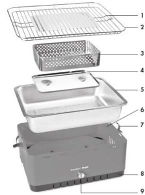
**IMPORTANT! Appliquer le gel combustible de sécurité à une distance minimale de 2 cm des trous.** Appliquez le gel combustible de sécurité à une distance d'au moins 2 cm des trous. (4). **NE METTEZ PAS LE GEL COMBUSTIBLE DE SECURITE DANS LES TROUS !**
